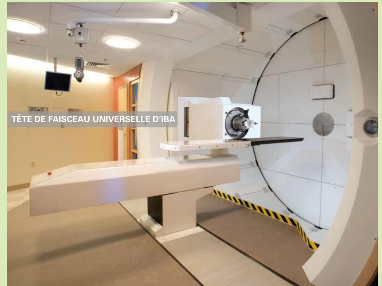
Une flexibilité maximale dans la formation et la direction du faisceau, avec 2 modes de balayage et 2 modes de diffusion - rendant superflue toute intervention manuelle pour passer de l'un à l'autre - fonctionnalités exclusives et uniques de la tête de faisceau universelle d'IBA.
